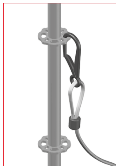
Rys. 3.10 – Mocowanie do tarczy otworowej
