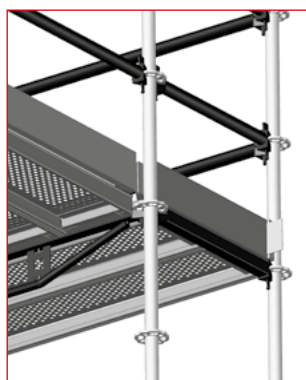
Rys. 3.24 – Narożnik wykonany za pomocą dwóch stojaków
