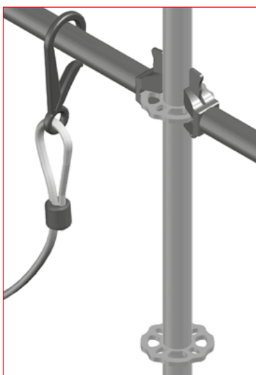
Rys. 3.9 – Mocowanie do rygła
