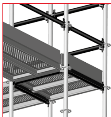
Rys. 3.26 – Narożnik wykonany za pomocą czterech stojaków
