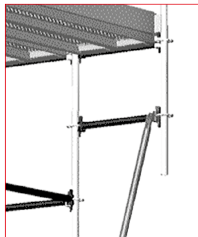
Rys. 3.29 – Rozszerzenie za pomocą rygli i stężeń
