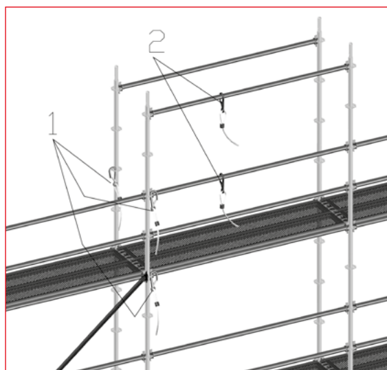
Rys. 3.8 – Miejsca mocowania środków ochrony osobistej
