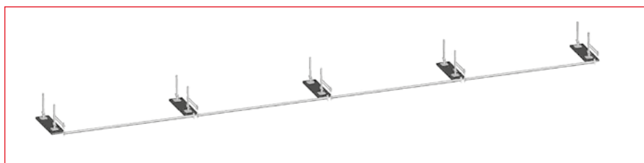
Рис. 3.52 - Этап 1 – Монтаж подставок
