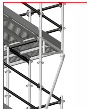
Рис. 3.25 - Угол, выполненный при помощи трех стоек, опоры и связи (см. рис. 3.28)
