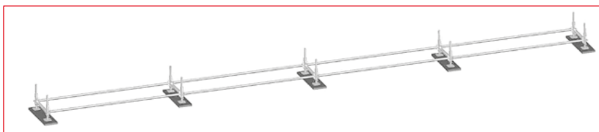
Рис. 3.54 - Этап 3 – Скрепление начальных элементов
