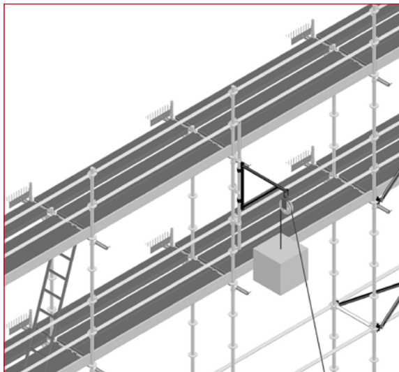
Рис. 3.79 – Леса с подъемником
