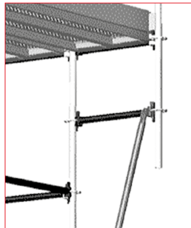
Рис. 3.29 – Расширение при помощи ригелей и связей
