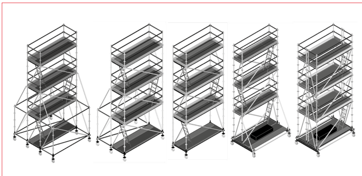
Рис. 3.71 – Передвижные леса в разных конфигурациях
