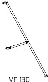
Алюминиевые стойки длиной 1,50 м, устанавливаются при помощи крепежей на вертикальную раму шириной 1,50 м. При более высокой стройке обеспечивают стабильность лесов.
