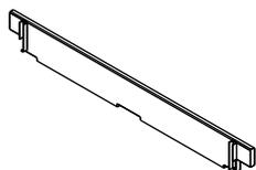
Защищает щит с короткой стороны. Деревянный, покрытый фталевой краской, с металлическими оконечниками, позволяющими монтаж без дополнительных креплений.
