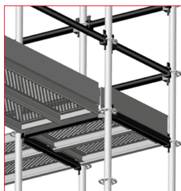
Rys. 3.26 – Narożnik wykonany za pomocą czterech stojaków
