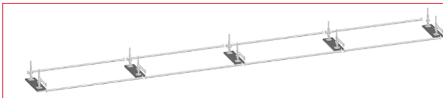
Rys. 3.53 – Etap 2 – Nalożenie elementów początkowych
