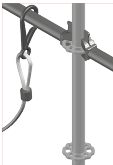
Rys. 3.9 – Mocowanie do rygla
