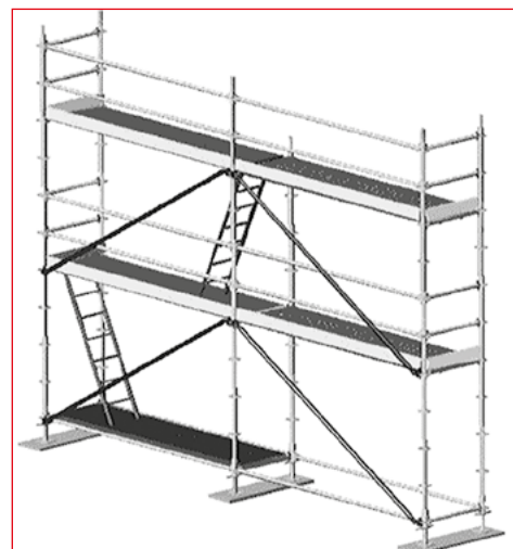
Rys. 3.23 – Przykład rusztowania z zabezpieczeniem bocznym
