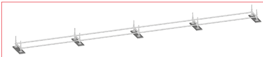
Rys. 3.54 – Etap 3 – Spinanie elementów początkowych
