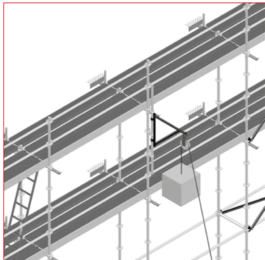
Рис. 3.79 – Леса с подъемником
