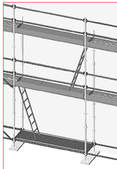
Рис. 3.41 – Подъем на леса с использованием проходных алюминиевых настилов, оснащенных алюминиевыми лестницами
