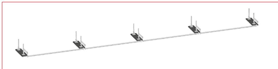
Рис. 3.52 - Этап 1 – Монтаж подставок
